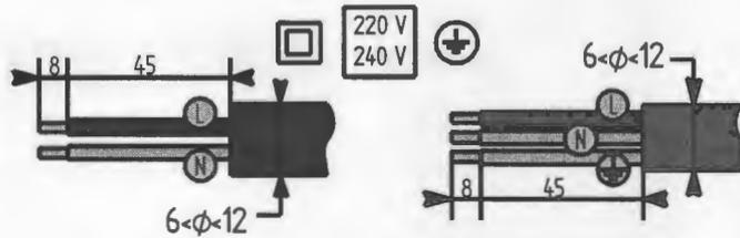
Conductor size 0,5mm<sup>2</sup> - 2,5mm<sup>2</sup>
